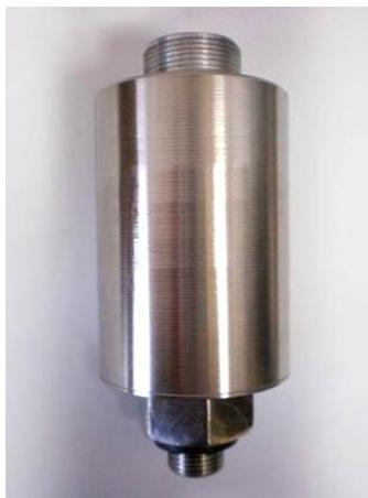
Датчики давления применяются в системах автоматического контроля и управления технологическими процессами в различных отраслях промышленности, в том числе в системах тепло-, газо- и водоснабжения, в компрессорных и гидравлических установках. Принцип действия преобразователей основан на преобразовании давления измеряемой среды, действующей на мембрану чувствительного элемента, в электрический сигнал, пропорциональный механической деформации мембранны.
