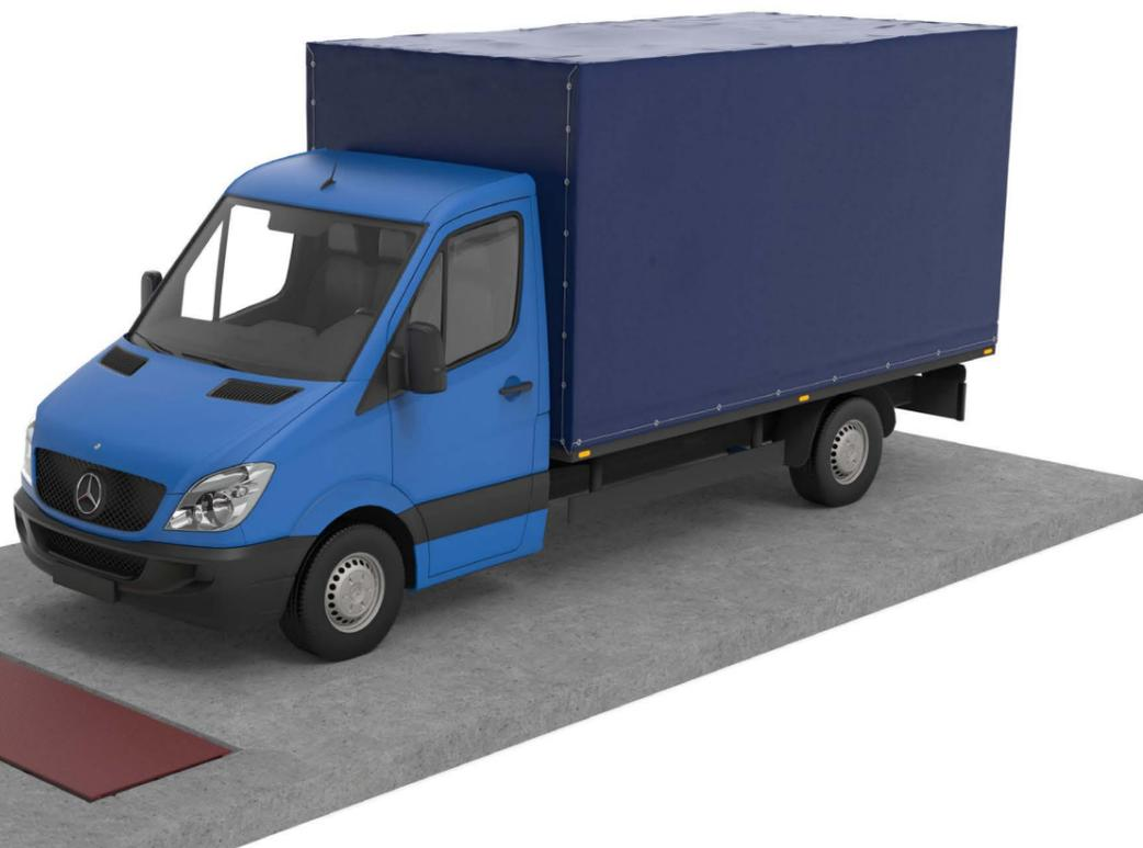
**ПООСЕВЫЕ ВЕСЫ ИЗМЕРЯЮТ МАССУ АВТОМОБИЛЯ ПОЭТАПНО, ВО ВРЕМЯ ЗАЕЗДА ТРАНСПОРТНЫМ СРЕДСТВОМ КАЖДОЙ ОСЬЮ НА ГРУЗОПРИЁМНОЕ УСТРОЙСТВО. ОБЩАЯ МАССА АВТОМОБИЛЯ, ВЫЧИСЛЯЕМАЯ СУММИРОВАНИЕМ.**
