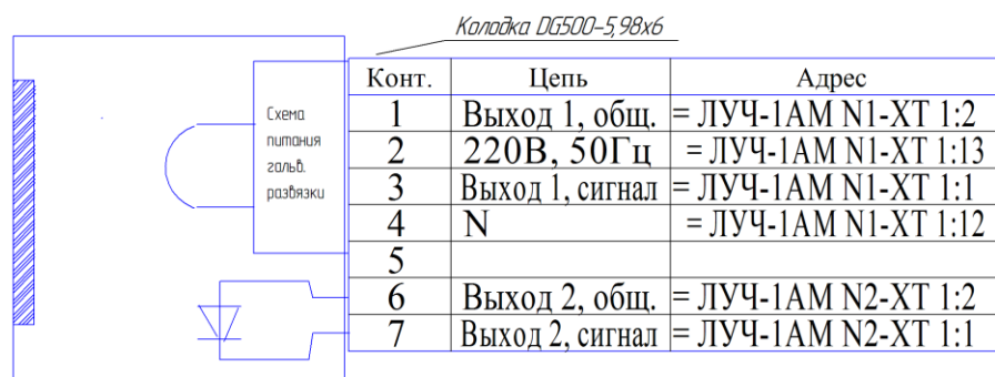
Рис.8. Выходные электрические цепи фотодатчика ФД-05ГМ.
