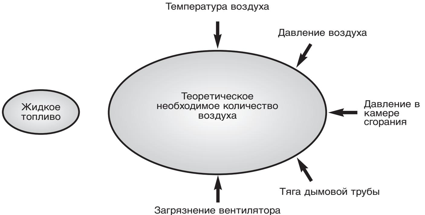
Теоретический объем воздуха, необходимый для качественного полного сгорания определенного количества жидкого топлива, может быть рассчитан.
