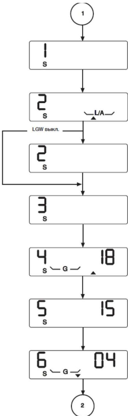
Запрос предохранительной цепи и регулятора температуры. Если они замкнуты, то процесс продолжается. В противном случае в режим Standby =“Выкл”.
