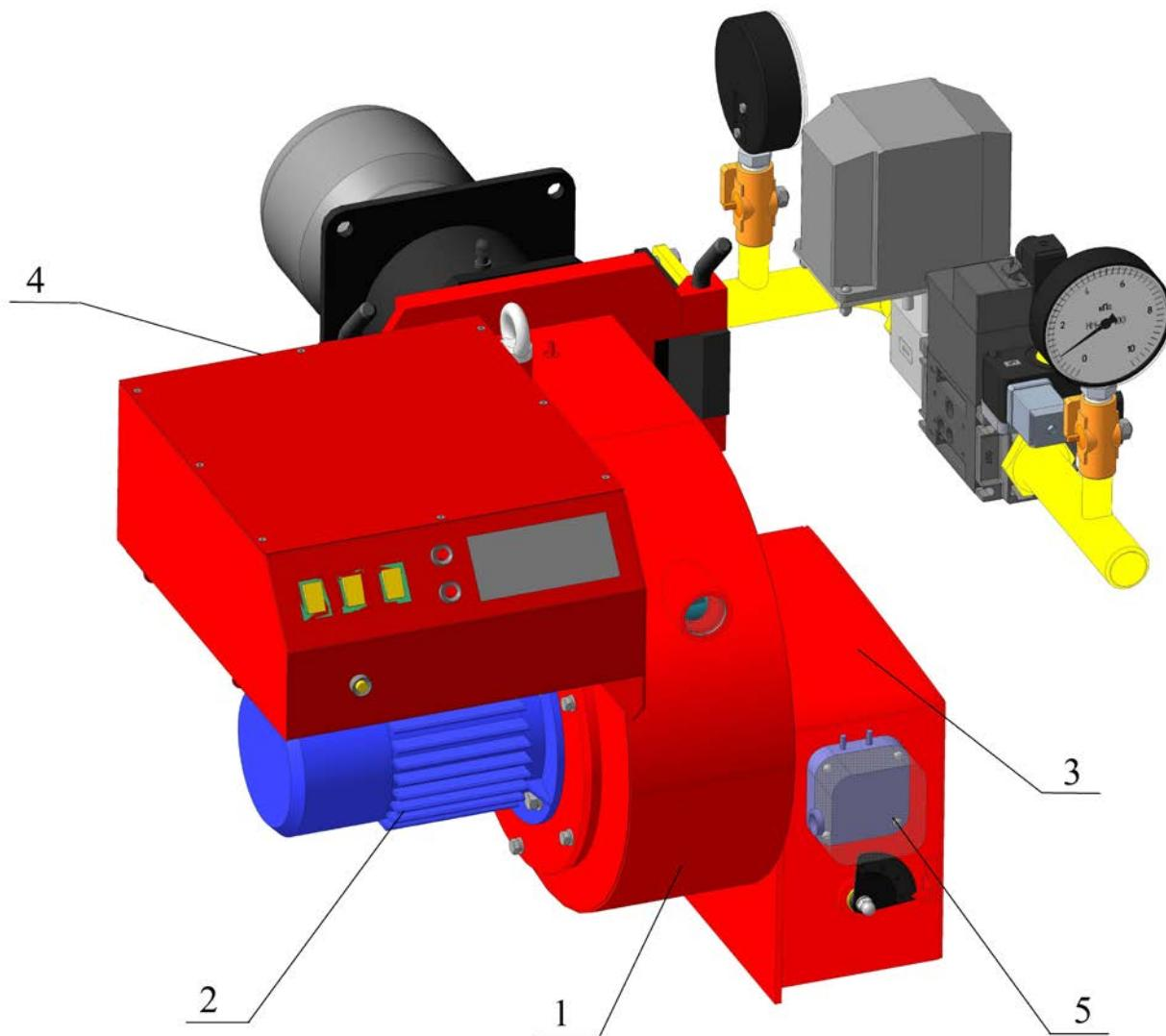
5.2. Горелка газовая предназначена для образования газо-воздушной смеси, зажигания и стабилизации газового факела. В корпусе горелки газовой установлен распределитель газа 1 и завихритель воздуха 2.
