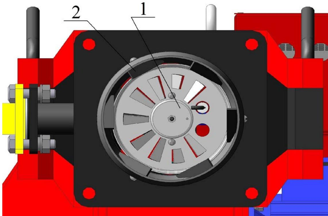
5.3. Распределитель газа представляет собой (см. Рис.4.): колено 1 с закреплёнными на нём электрода розжига 2, насадки 3 и стабилизатора 4. В распределителе установлен рассекатель 5, который имеет возможность перемещаться относительно насадки 3 для регулирования расхода газа. Для регулирования скорости воздуха (длины факела) на колене 1 имеются продольные отверстия по которым насадка может перемещаться вдоль колена.
